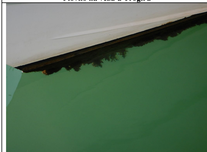
Podvodni dio je zahvaćen sa morskim raslinjem
