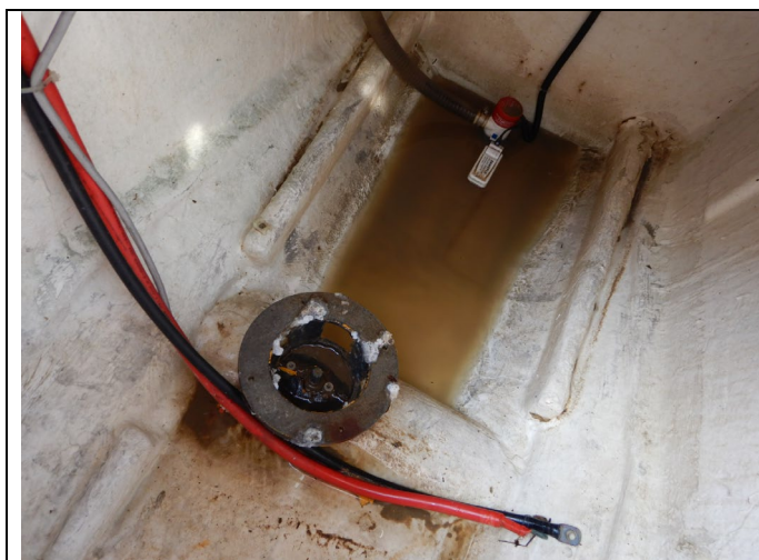
Motor pramčanog propelera je demontiran
