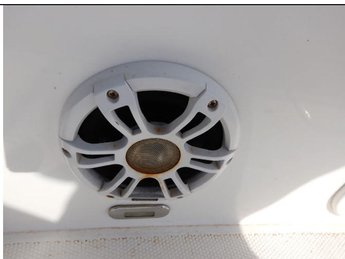
Zvučnici su korodirani
